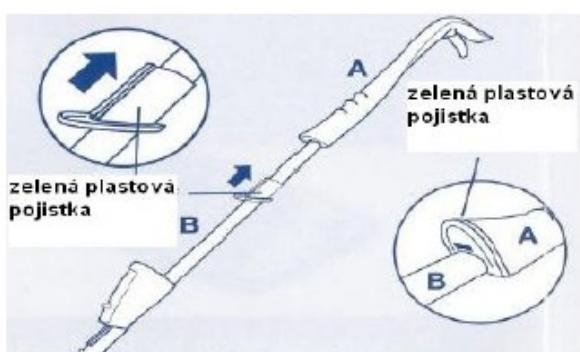
3) Napojte spodní tyč B na držák mopu C. Dejte velkou plastovou pojistku na spodní tyči B do velkého otvoru na držáku mopu C. Točte se spodní tyčí B do doby, než zapadne malá kovová pojistka do malého otvoru.
